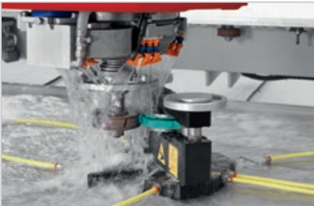
Dynamic lock auf kleinem Werkstück mit 30 mm.
