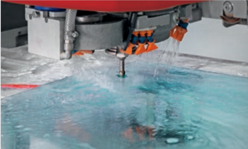
Integriertes Bohren mit Helix-System.
