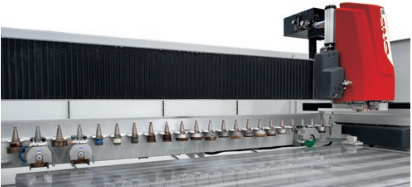
Rückseitiges Werkzeugmagazin mit 23 Positionen.
