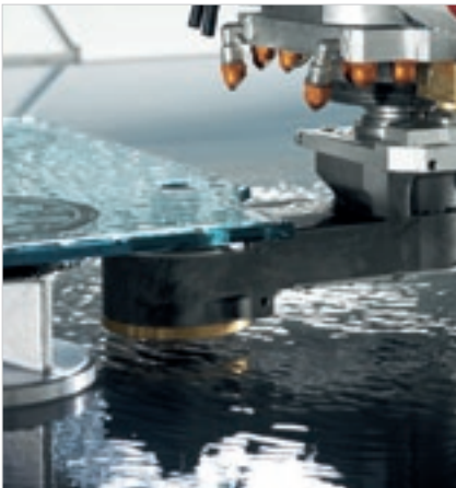
Bohren von unten mit Aggregat.
